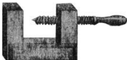
Фиг. 61. Большая деревянная струбцина.
