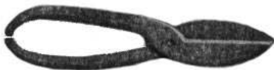
Фиг. 22. Ножницы для резки металлов.
